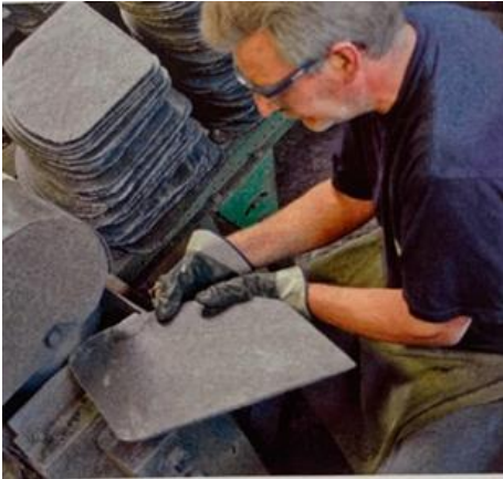
Abbildung: Zurichten des Schiefers. Quelle: Hans Dürr, S. 327
