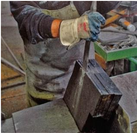
Abbildung: Spalten des Schiefers. Quelle: Hans Dürr, S. 327
